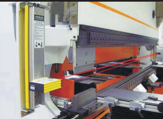
Fotos : segurança em prensas dobradeiras sem perda de produção. AKAS 3F
